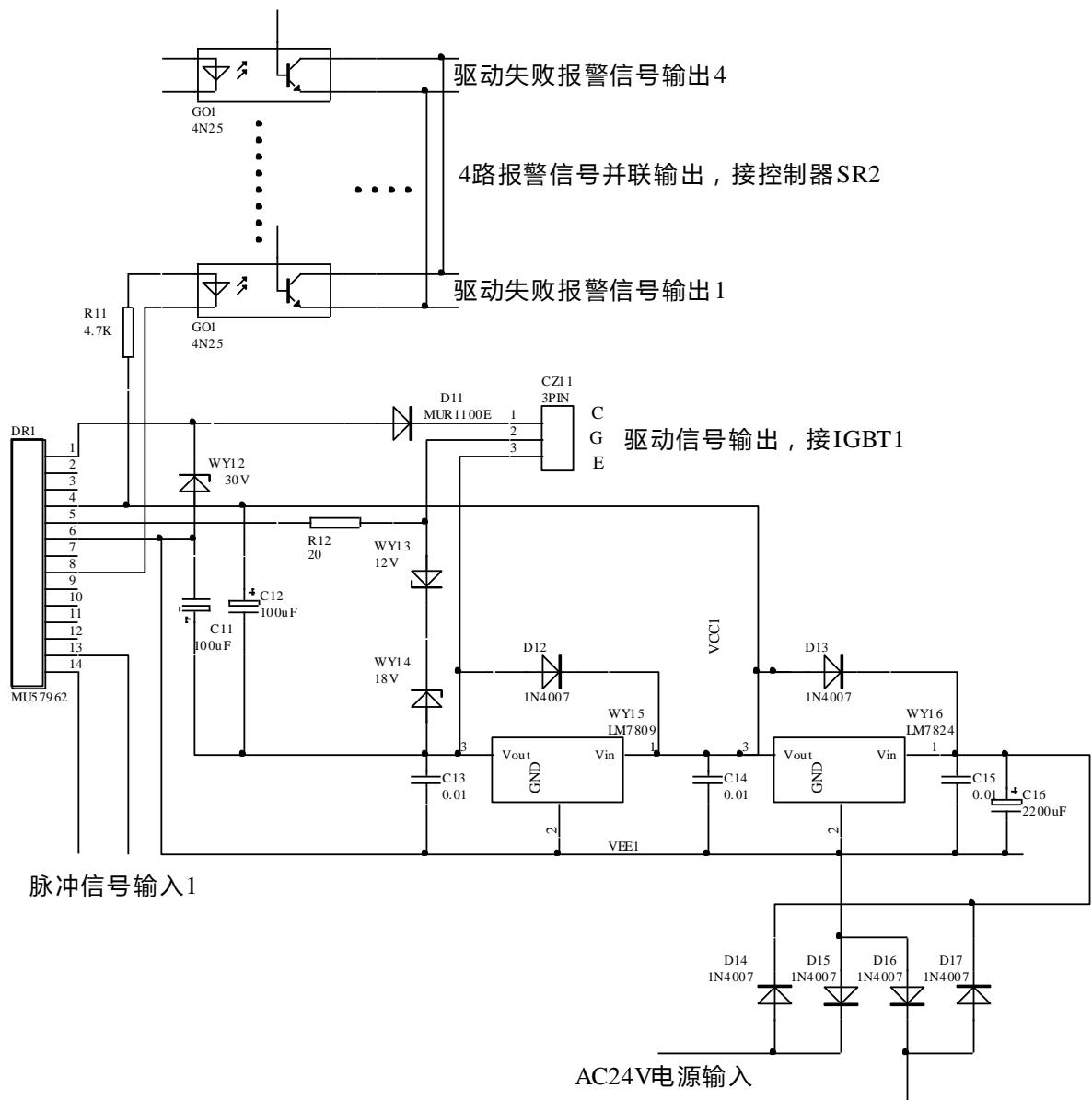
图十、驱动单元电路
