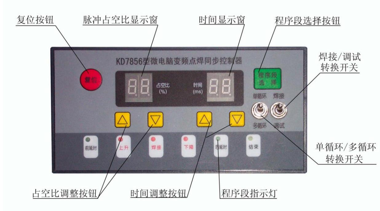
图十五、控制器的面板布置
