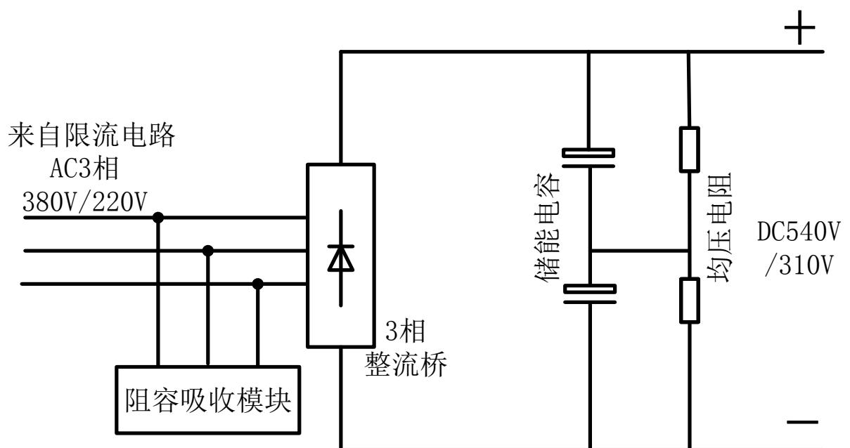
图七、整流及储能电路
