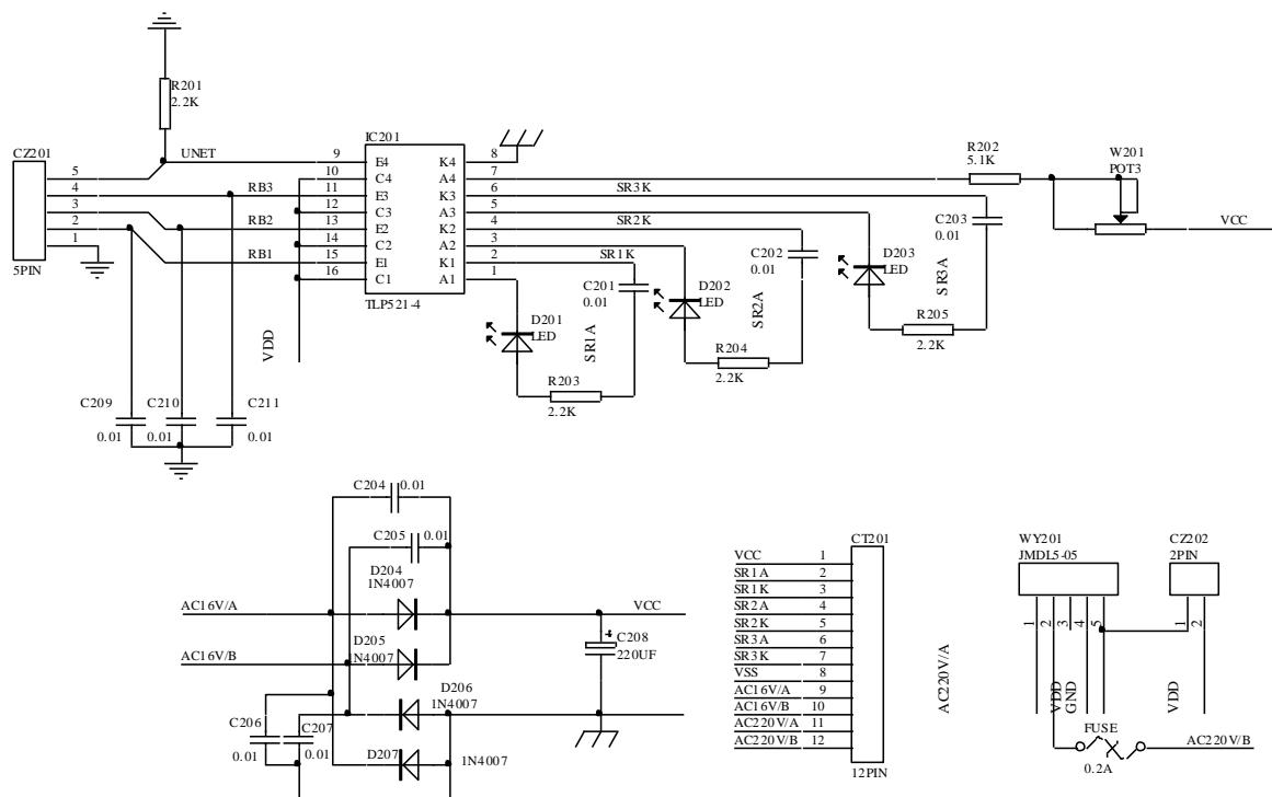
图十七、控制器电源电路
