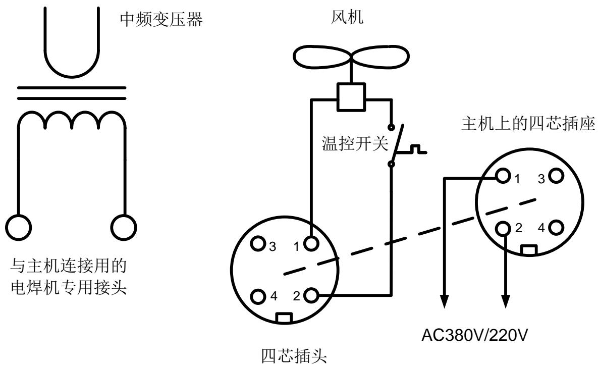
图十一、中频变压器单元电路
