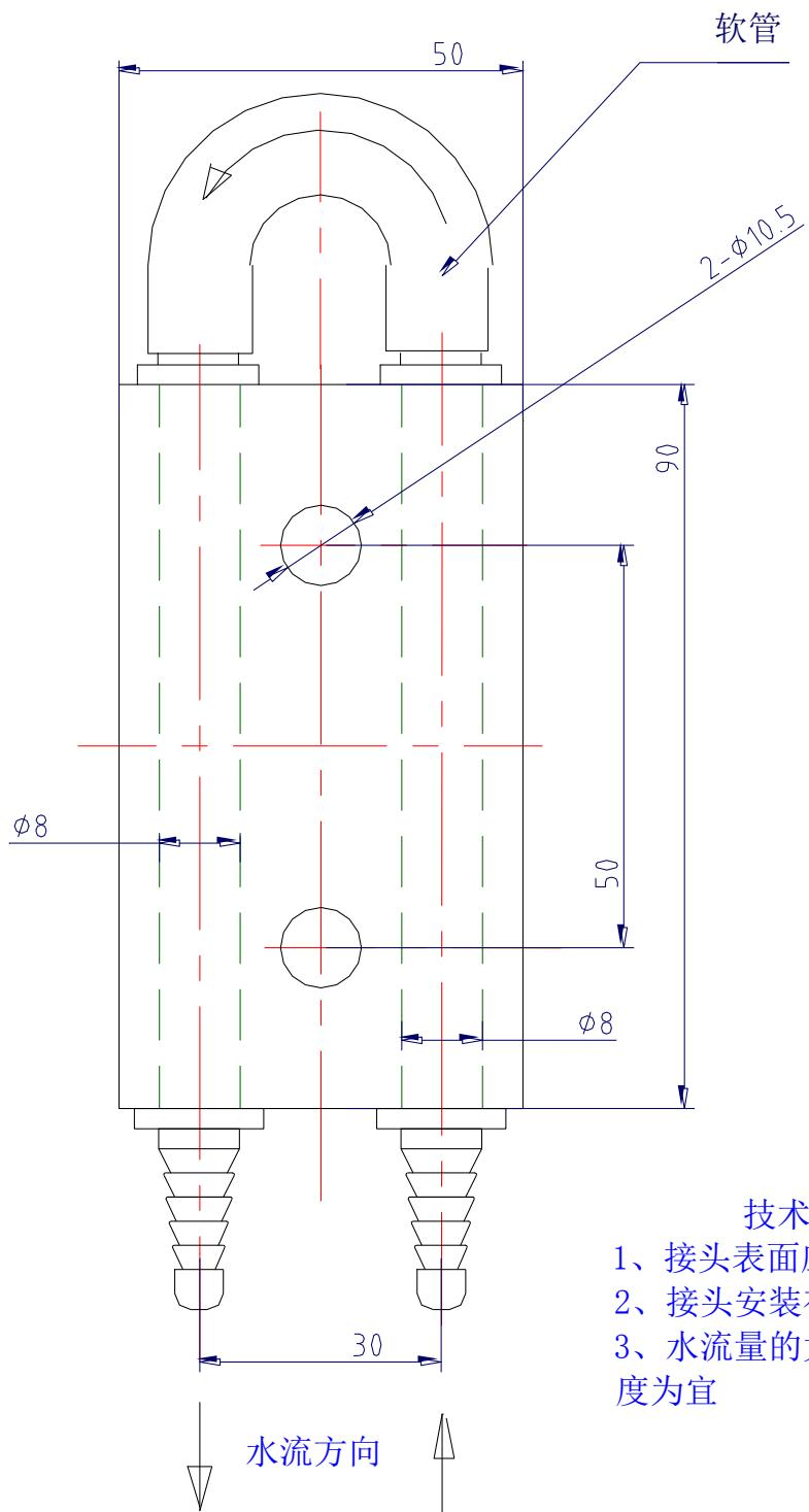
图十四、变压器水冷接头示意图
