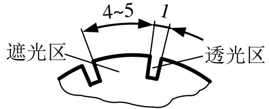
图三、计数盘透光槽宽度示意图
